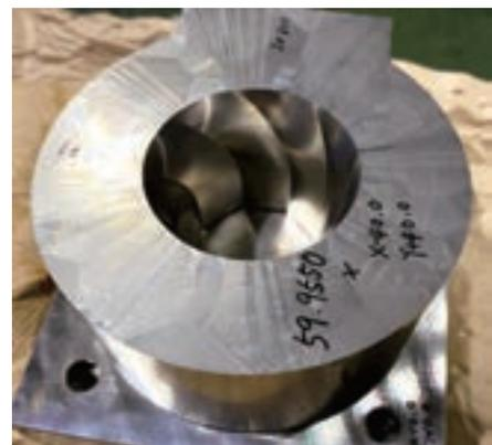
図 2 : 金型写真 (可動側入れ子)
