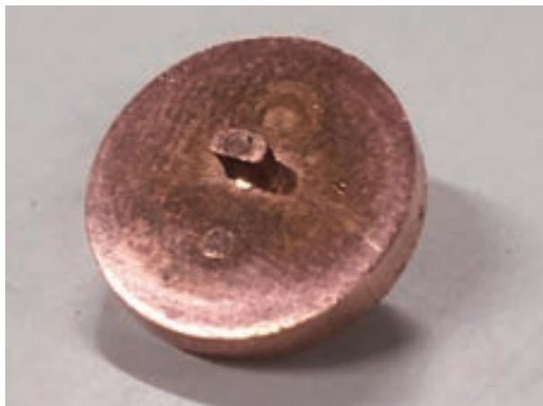
図 6.2 外形抜き後 (試作品)
