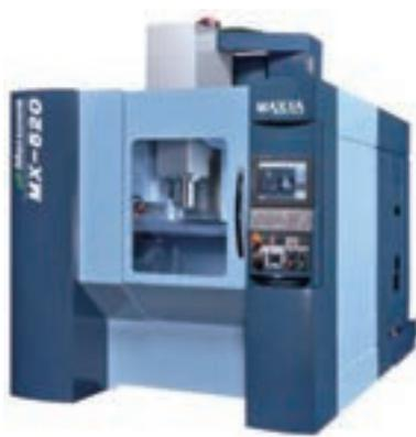
図 21 5 軸制御立形マシニングセンタ
