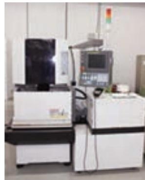
(c) ワイヤ放電加工機 ROBOCUTα0iC
