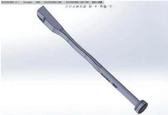
図 11. 傾斜ピン 3D モデル
