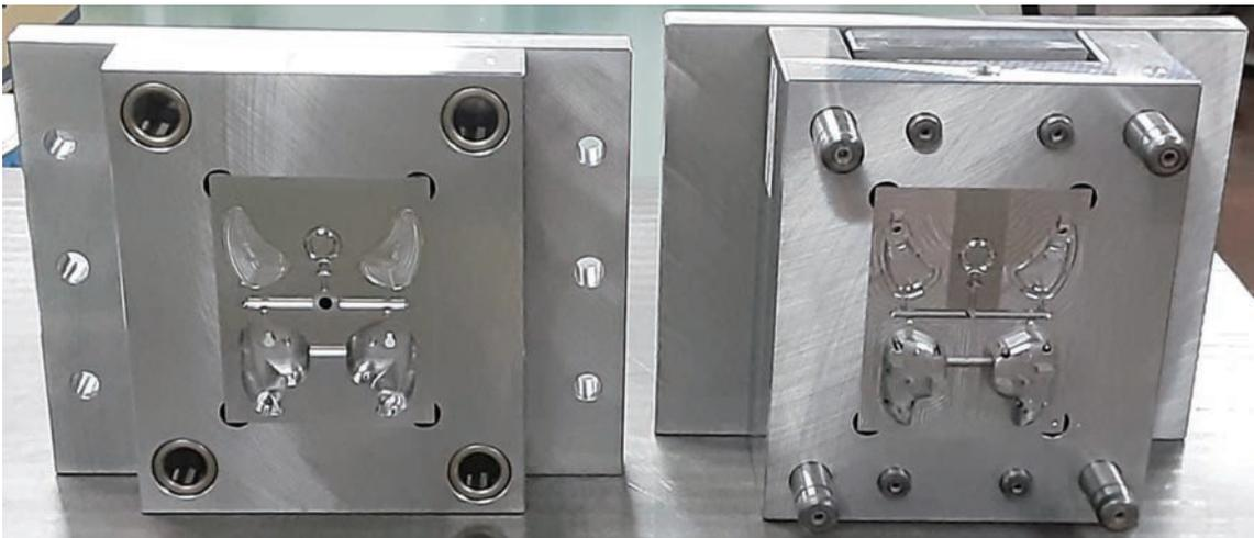
図1 飾り小物金型 固定側 (左) と可動側 (右)
