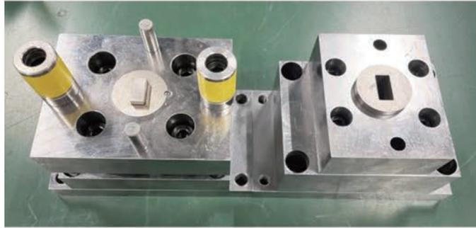
図 5.4 3 工程目 (成形) 金型 (左:下型 右:上型)
