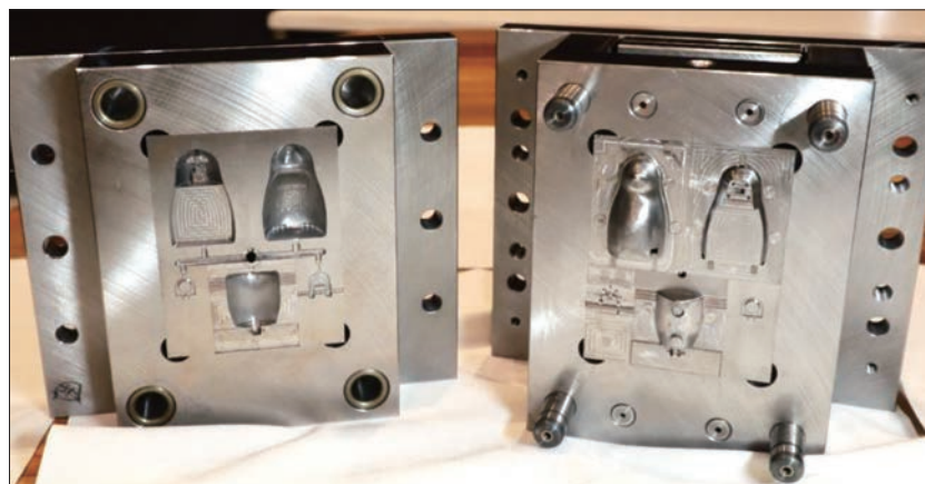
図1 飾り小物 金型 固定側 (左) ・可動側 (右)
