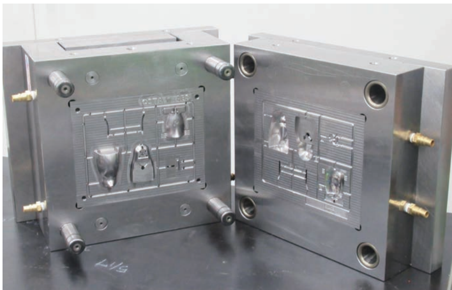
図2 二次成形金型 (左：可動側 右：固定側)
