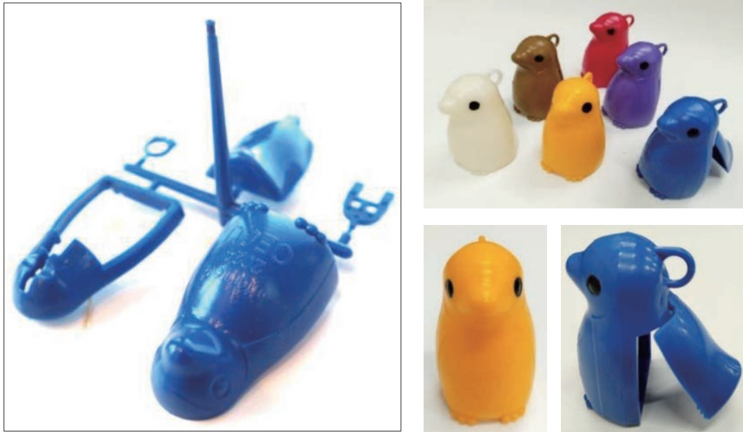
図2 飾り小物 成形品（左）・組立て製品（右）（成形材料：デンカ ABS QF(MFR44)）
